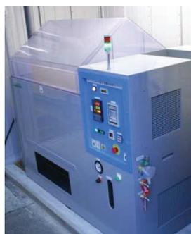
Cámara de simulación de altitud
