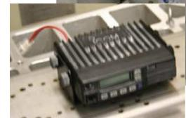
Prueba de vibración
